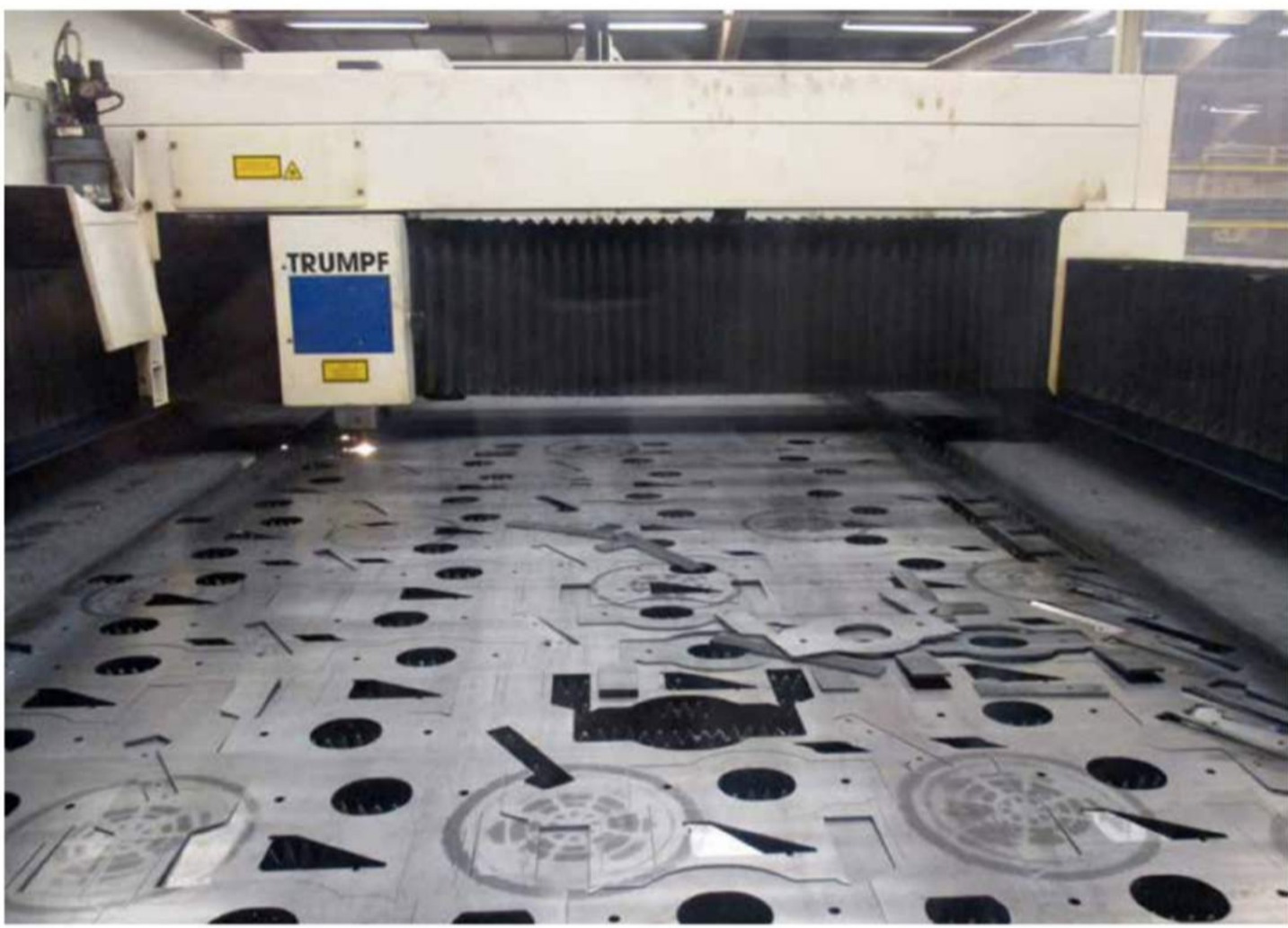
De goede plaatkwaliteit zorgt dat bij het nesten het volle rendement uit de plaat kan worden gehaald.
