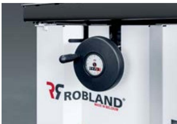
Volant avec vernier pour le réglage en hauteur de la toupie.
