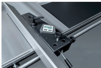
Digitale uitlezing op de parallelgeleider type Z3 Digital readout on the parallel fence type Z3 Affichage numérique sur le guide parallèle type Z3
