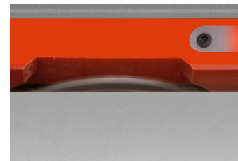
Automatisch op en neer bewegen van de ritser Automatic up and down movement of the scoring blade Mouvement automatique de haut en bas de la scie inciseur
