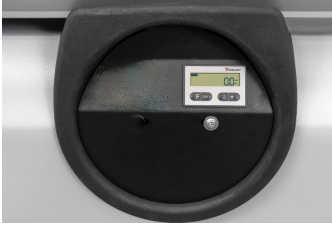
Digitale uitlezing van de zaaghoek. Digital readout of the cutting angle. Affichage numérique de l'angle de coupe
