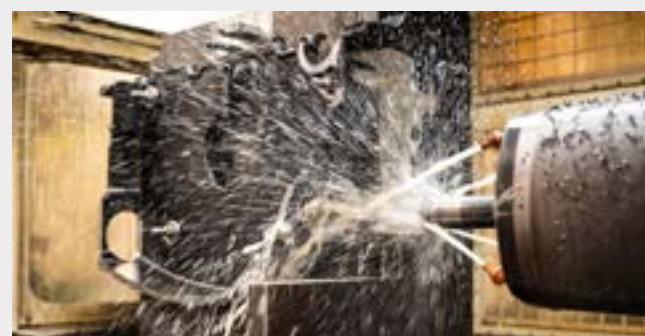
Usinage CNC d'un berceau de scie en fonte
