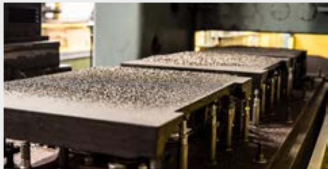
Rectification d'une table en fonte
