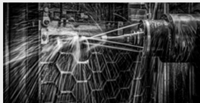
Usinage CNC d'une table en fonte
