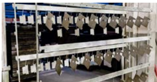
Préparation pour peinture en poudre époxy
