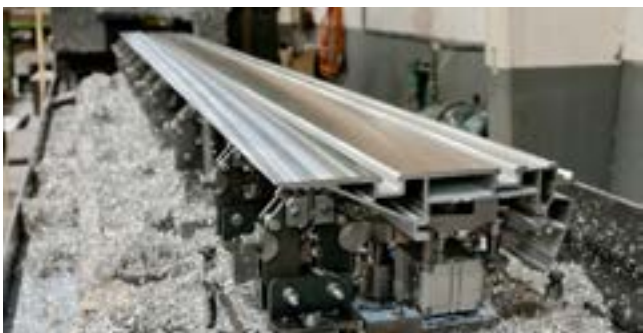
Frezen van de oppervlakte van de loopwagen
