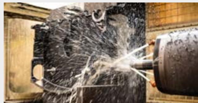
CNC gestuurde bewerkingen op de gietijzeren zaagbeugel
