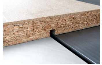
Voorbereiding voor groeffrees max 16 mm Preparation for groove cutter max 16 mm Préparation pour fraise à rainurer max 16 mm
