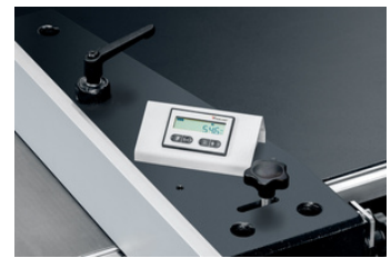
Digitale uitlezing op de parallelgeleider type Z4 Digital readout on the parallel fence type Z4 Affichage numérique sur le guide parallèle type Z4
