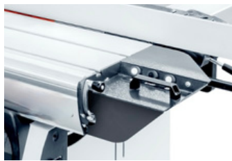
Start-stop in het loopwagendhandvat (draadloos) Start-stop in the sliding table handle (wireless) Démarrage-arrêt dans le chariot de scie (sans fil)
