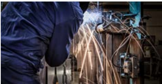
Lassen van een chassis
