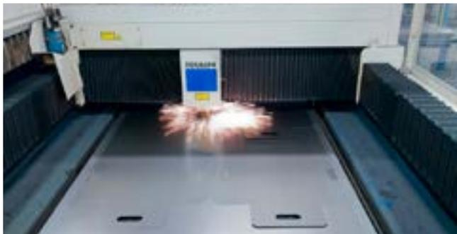
Découpe laser d'une tôle d'acier
