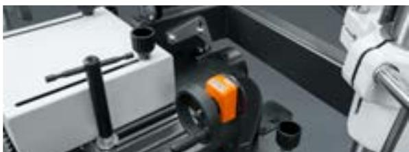
Positionnement et micro ajustement par volant avec compteurs mécaniques. Le lourd capot de protection se déplace sur des guides linéaires ergonomiques pour une référence facile et une précision accrue.
