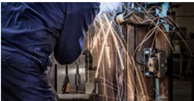
Lassen van een chassis
