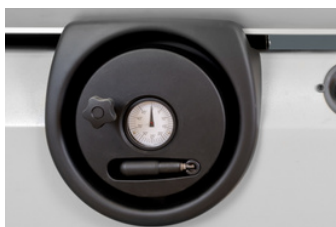
Analoge uitlezing van de zaaghoek. Analoge readout of the cutting angle. Lecture analogique de l'angle de coupe.
