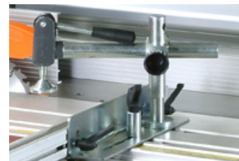
Excentrische houtklem Excentric wood clamp Presseur à bois excentrique
