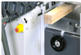
Handwiel met uitleesklok schaaft hoogte Handwheel with readout planing height Volant avec vernier, réglage en hauteur raboteuse
