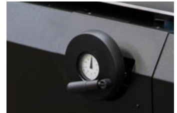
Analoge uitlezing van de zaaghoek. Analogue readout of the cutting angle. Lecture analogique de l'angle de coupe.
