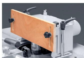
Pennenkap voor snijgereedschappen tot dia 250 mm Tenoning safety hood for cutting tools up to dia 250 mm Capot à tenonner (diam. outil 250 mm)
