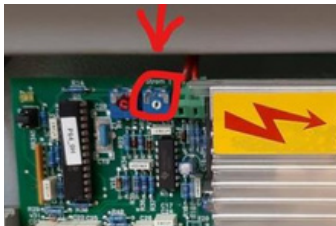
Elektronische motorrem (verplicht bij zware gereedschappen) Electronic braking system (mandatory for heavy tools) Module électronique de freinage moteur (obligatoire pour les outils lourds)
