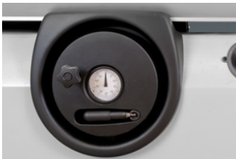
Analoge uitlezing van de zaaghoek. Analogue readout of the cutting angle. Lecture analogique de l'angle de coupe.
