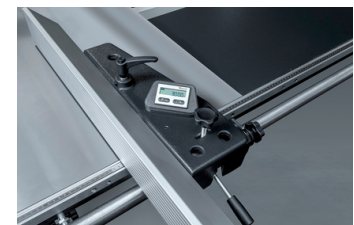
Digitale uitlezing op de parallelgeleider type Z3 Digital readout on the parallel fence type Z3 Affichage numérique sur le guide parallèle type Z3
